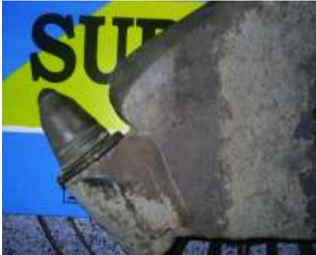
Fig. 2. Uzare de abraziune sub presiune scazută și medie (rizuri și ciupituri)
